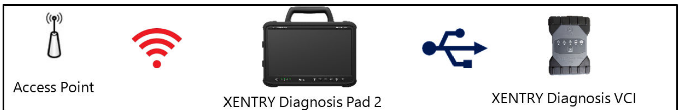
Fig. 18: Variante de conexão 2: WLAN e USB
