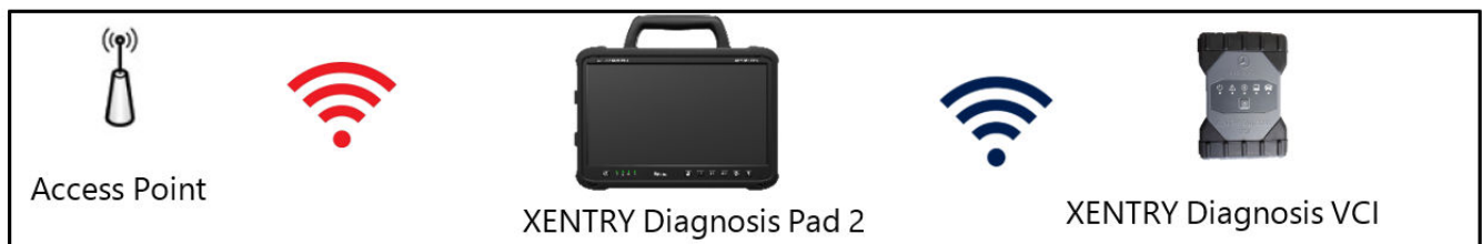
Fig. 17: Variante de conexão 1: WLAN e WLAN
