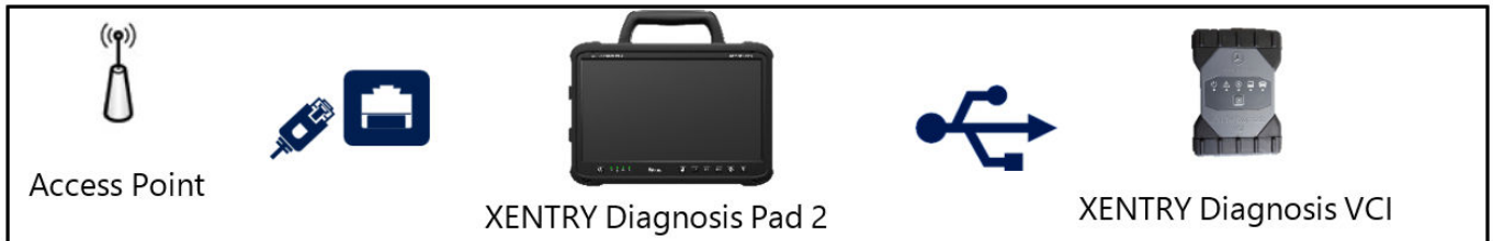
Fig. 20: Variante de conexão 4: LAN e USB
