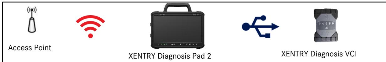
Abbildung 18: Verbindungsvariante 2: WLAN und USB
