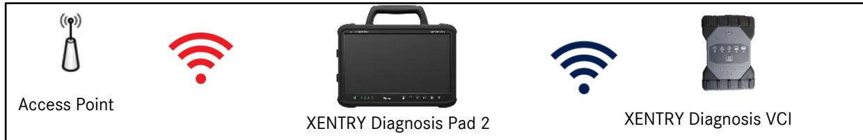
Abbildung 17: Verbindungsvariante 1: WLAN
