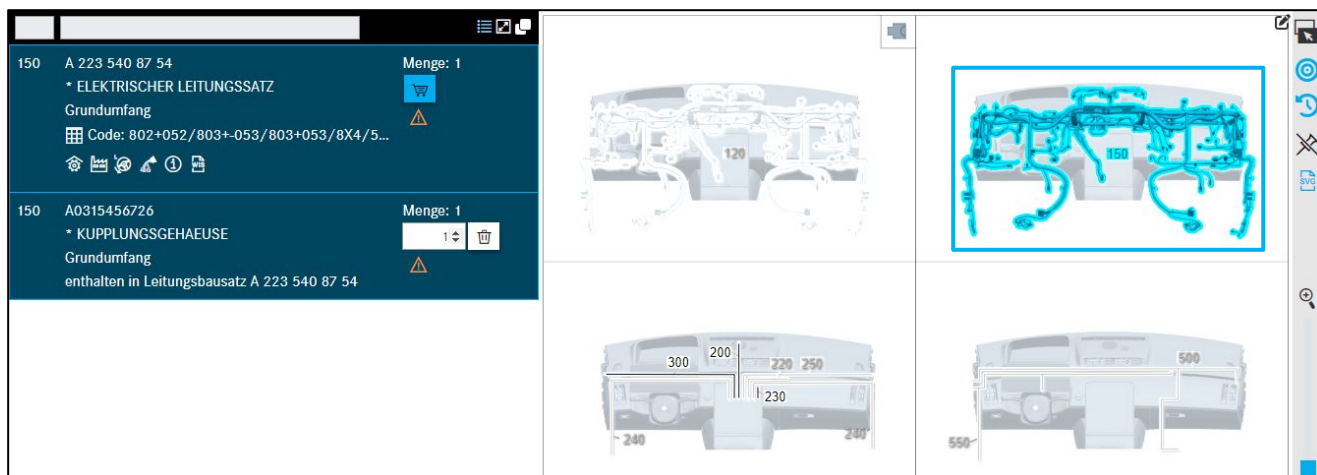
Figura 226 „Piesa din modulul cablajelor”
