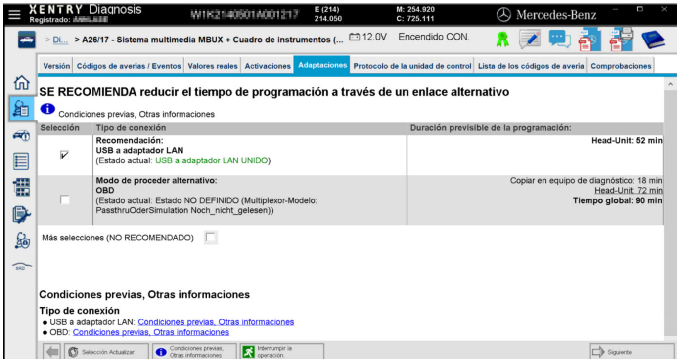
Fig. 20: XENTRY Diagnosis: selección del tipo de conexión de la programación de unidades de control
