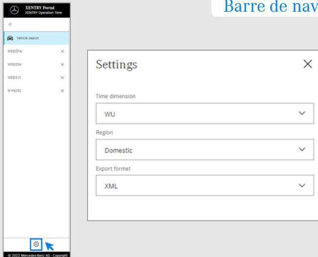
Cliquez sur l'icône d'engrenage pour ouvrir les paramètres XOT qui apparaissent sur le côté droit de l'écran. En fonction de vos droits d'utilisateur, vous pouvez ajuster les paramètres de l'unité, de la région et du format d'exportation ici.
