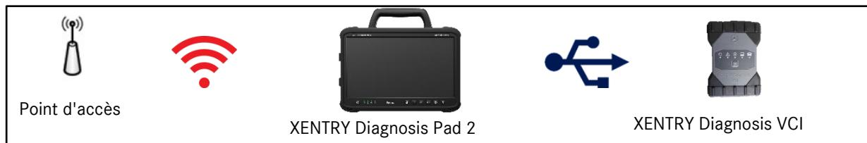
Illustration 19 : Variante de connexion 2 : WLAN et USB
