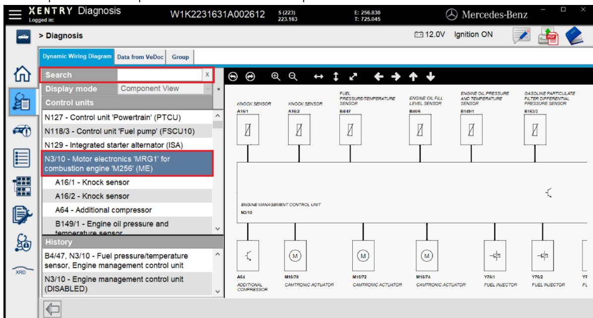
Illustration 41: Aperçu des composants au sein du schéma électrique
