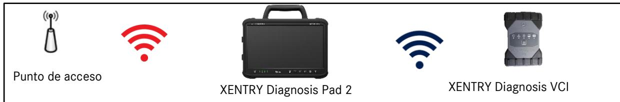
Ilustración 18: Variante de conexión 1: WLAN
