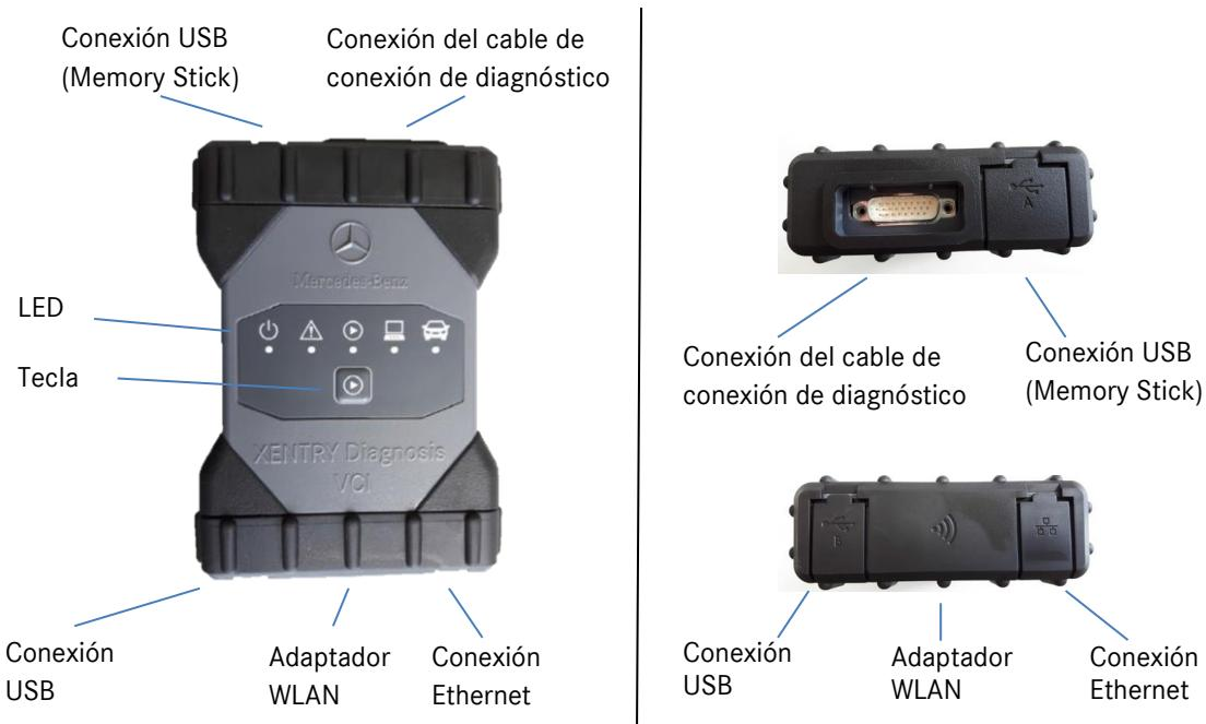
Ilustración 46: Conexión del XENTRY Diagnosis VCI
