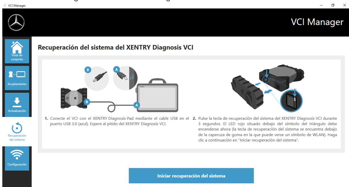
Ilustración 59: Recuperación del sistema del XENTRY Diagnosis VCI
