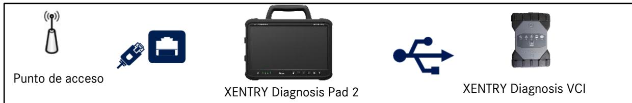
Ilustración 21: Variante de conexión 4: LAN y USB
