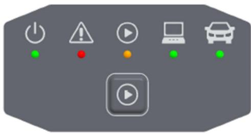
Ilustración 47: Indicadores de estado y elementos de mando del XENTRY Diagnosis VCI
