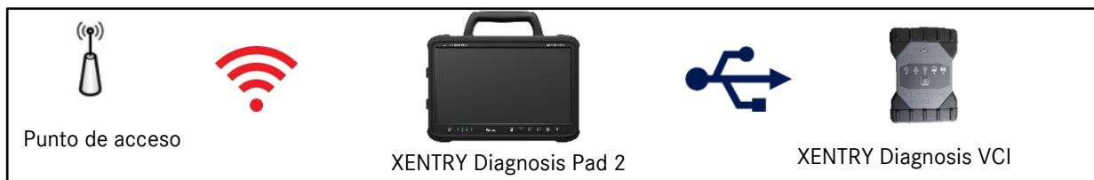
Ilustración 19: Variante de conexión 2: WLAN y USB
