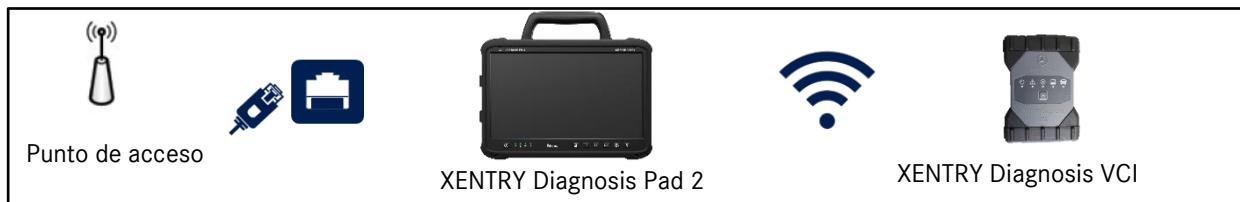
Ilustración 20: Variante de conexión 3: LAN y WLAN
