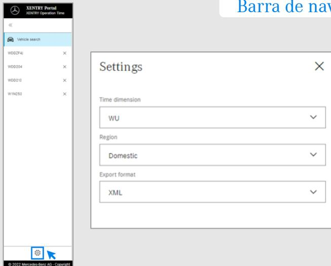
Haga clic en el icono de engranaje para abrir los ajustes XOT que aparecen en el lado derecho de la pantalla. Dependiendo de sus derechos de usuario, puede ajustar la configuración de la unidad, **región** y formato de exportación aquí.
