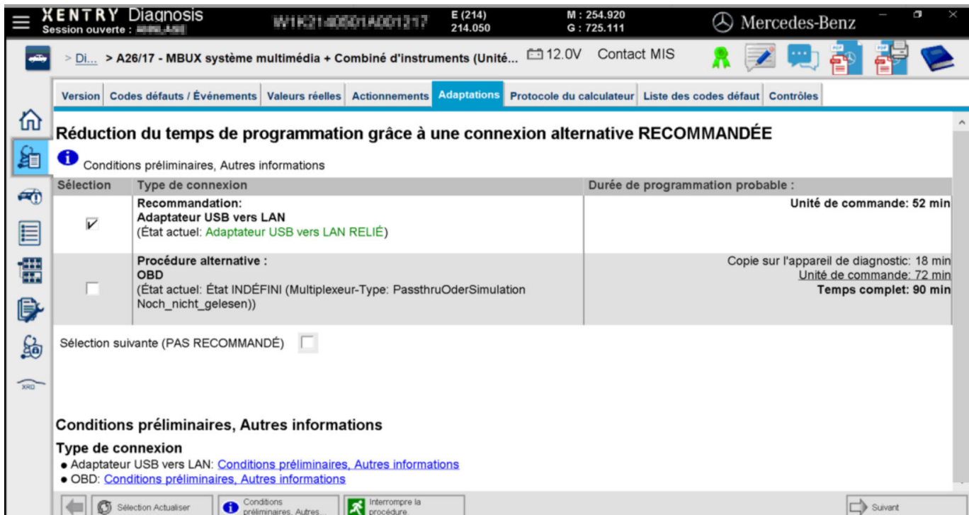
Fig. 20 : XENTRY Diagnosis : sélection du type de connexion de la programmation du calculateur
