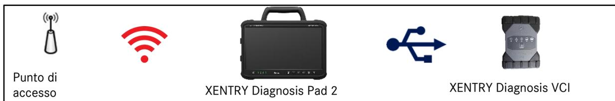
Figura 19: Variante di collegamento 2: WLAN e USB
