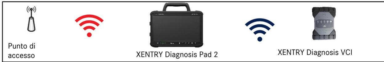
Figura 18: Variante di collegamento 1: WLAN
