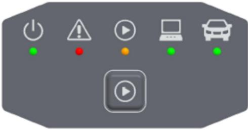
Figura 47: Indicazione di stato ed elementi di comando XENTRY Diagnosis VCI
