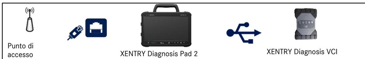
Figura 21: Variante di collegamento 4: LAN e USB
