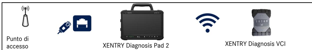
Figura 20: Variante di collegamento 3: LAN e WLAN
