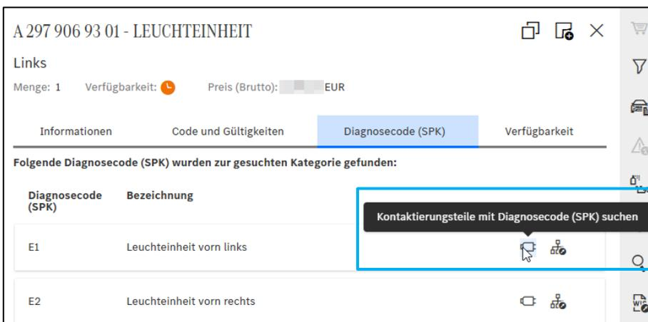
Abbildung 156 "Suche nach Leitungsbausatz mit Diagnosecode (SPK)"
