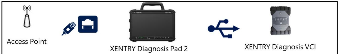
Abb. 20: Verbindungsvariante 4: LAN und USB
