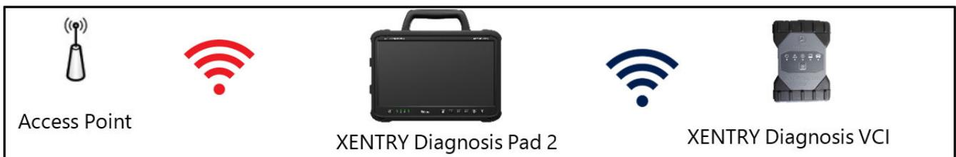
Abb. 17: Verbindungsvariante 1: WLAN und WLAN
