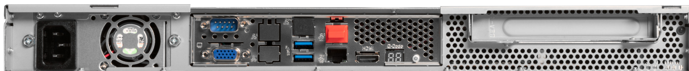
Fig. 6 : Face arrière avec port admin du Retail Data Storage 2
