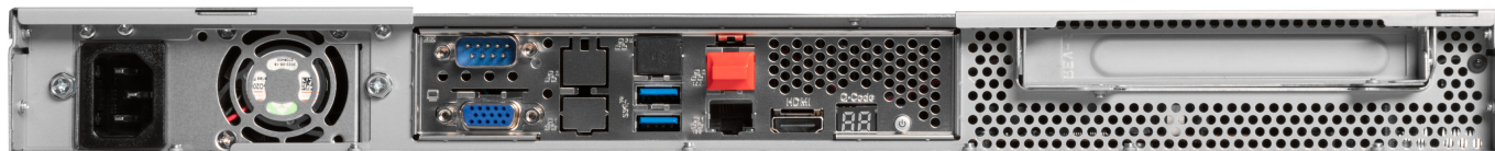
Fig. 6: Lato posteriore con porta Admin del Retail Data Storage 2
