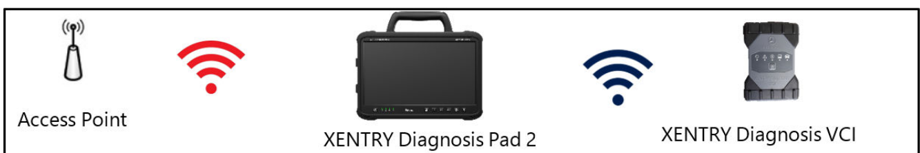
Fig. 17: Variante di collegamento 1: WLAN e WLAN
