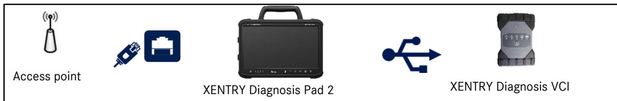
Figura 18: Variante de conexão 4: LAN e USB
