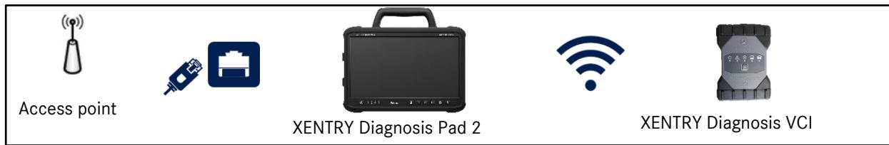
Figura 17: Variante de conexão 3: LAN e Wi-fi
