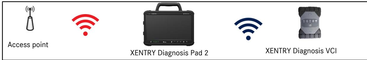
Figura 15: Variante de conexão 1: Wi-fi
