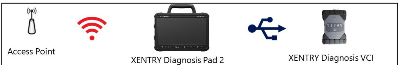
Fig. 18 : Variante de connexion 2 : Wi-Fi et USB
