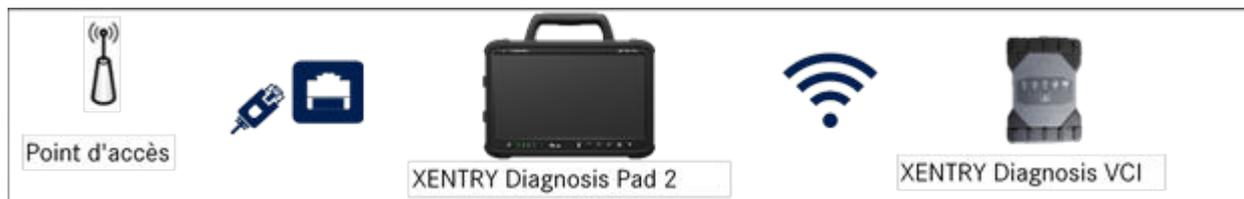
Fig. 19 : Variante de connexion 3 : LAN et Wi-Fi
