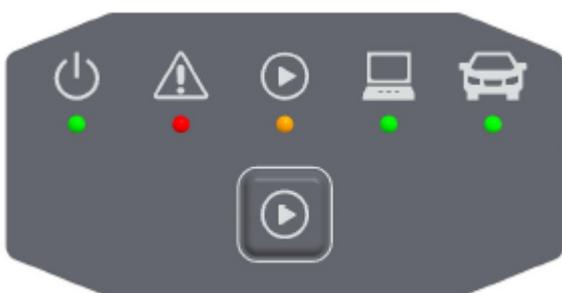
Fig. 42 : Affichage d'état et éléments de commande du XENTRY Diagnosis VCI
