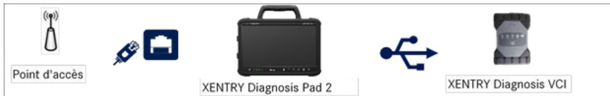
Fig. 20 : Variante de connexion 4 : LAN et USB
