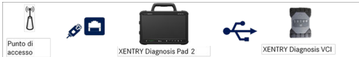
Fig. 20: Variante di collegamento 4: LAN e USB
