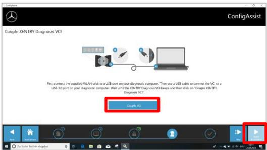
**Primero**, insertar el dispositivo para Wi-Fi en el ordenador de diagnóstico. Conectar el VCI con el ordenador vía cable USB y esperar a escuchar un **pitido**.
