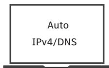
Configurez l'interface réseau sur l'appareil de configuration de la façon suivante : Obtenir automatiquement l'adresse IP - Obtenir automatiquement l'adresse du serveur DNS
